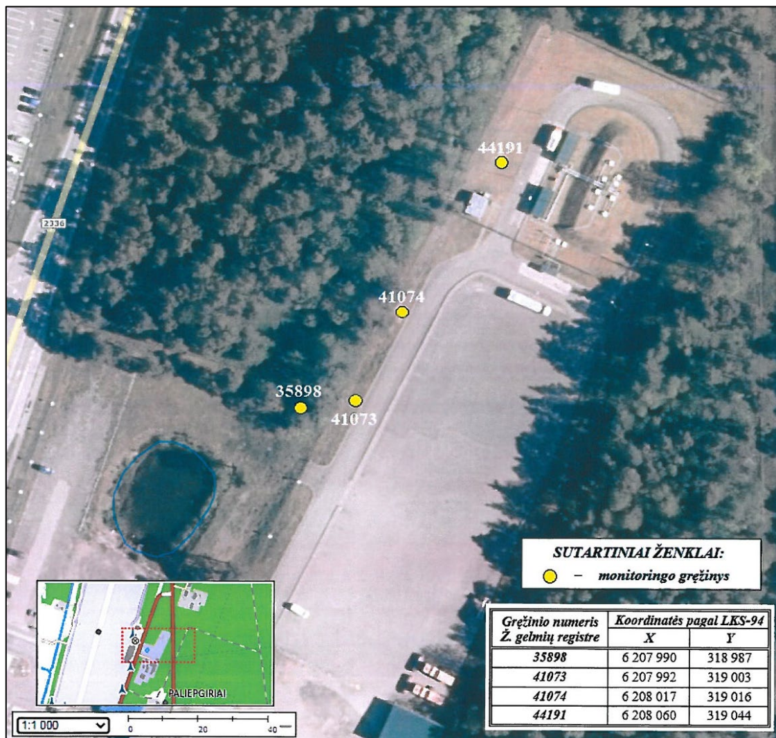
2 pav. Kuro bazės poveikio požeminiam vandeniui monitoringo tinklo schema
